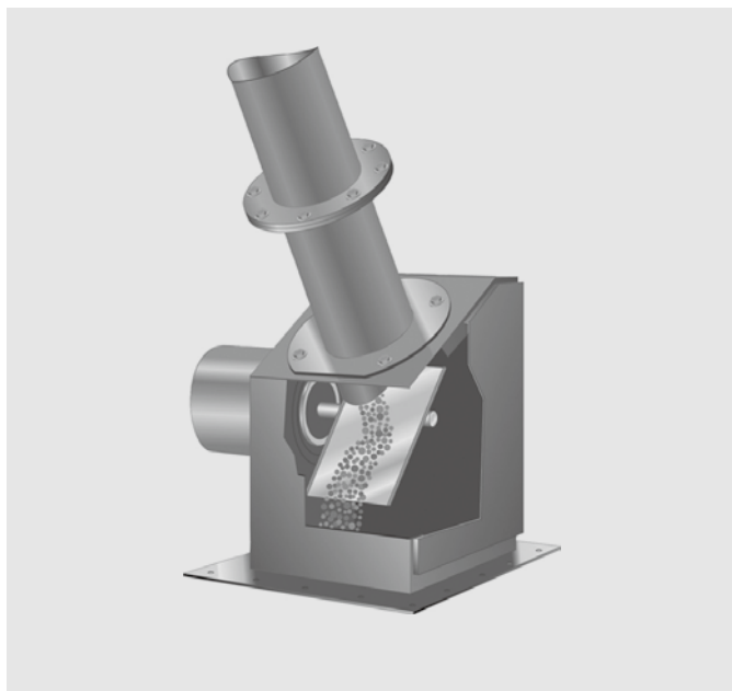
固体流量计及其称量板示意图
